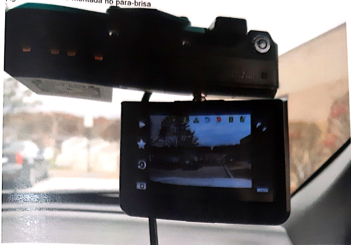
Figura 3 - Câmera montada no para-brisa
