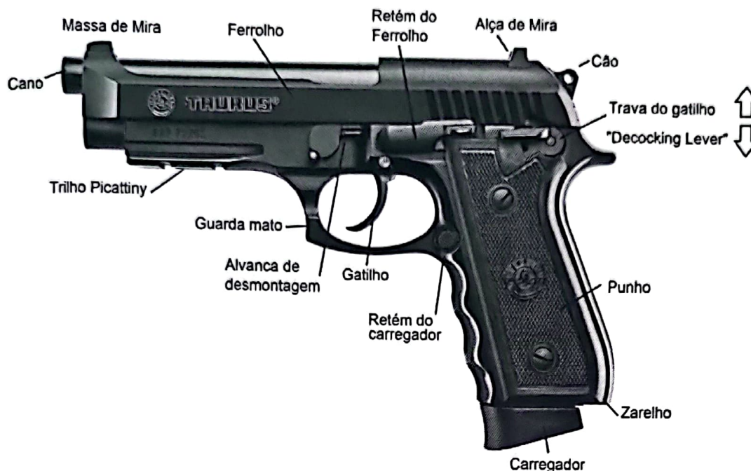
Figura 37: Partes básicas da pistola Taurus PT100 .40 S&W.
