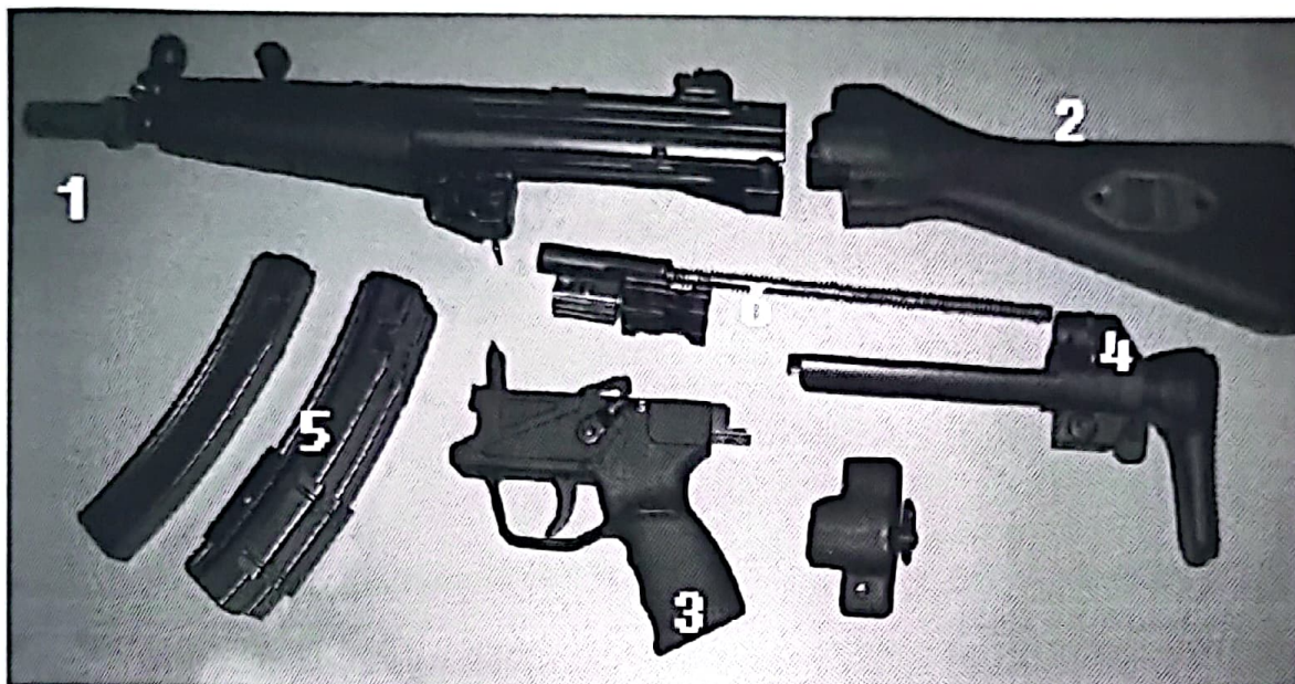
Figura 21: Partes básicas da Mtr M H&K MP5 calibre 9mm Para.
