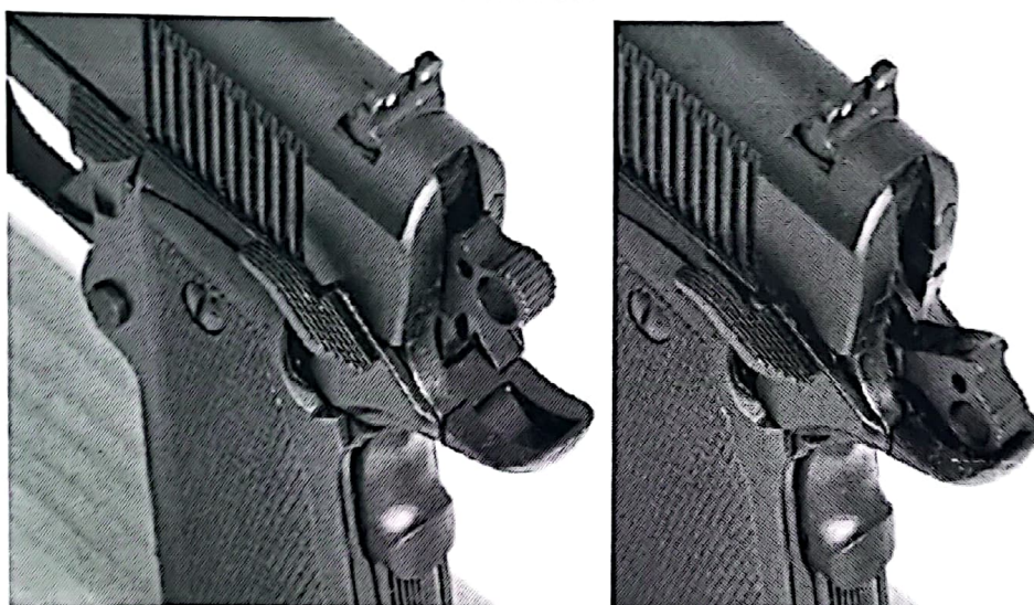
Figura 35: À esquerda o cão rebatido e a trava lateral levantada; e à direita o cão engatilhado e a trava abaixada na Pistola IMBEL .40 CG MD5 .40S&W.
